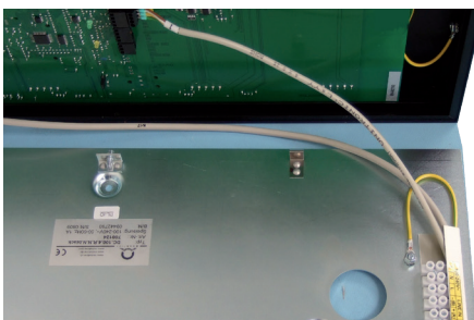
Ansicht Rückwand der Digitaluhr mit Klemmleiste
